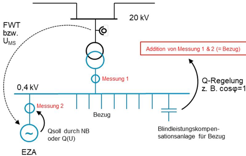
Bild L.2: Addition von Messung 1 und 2
