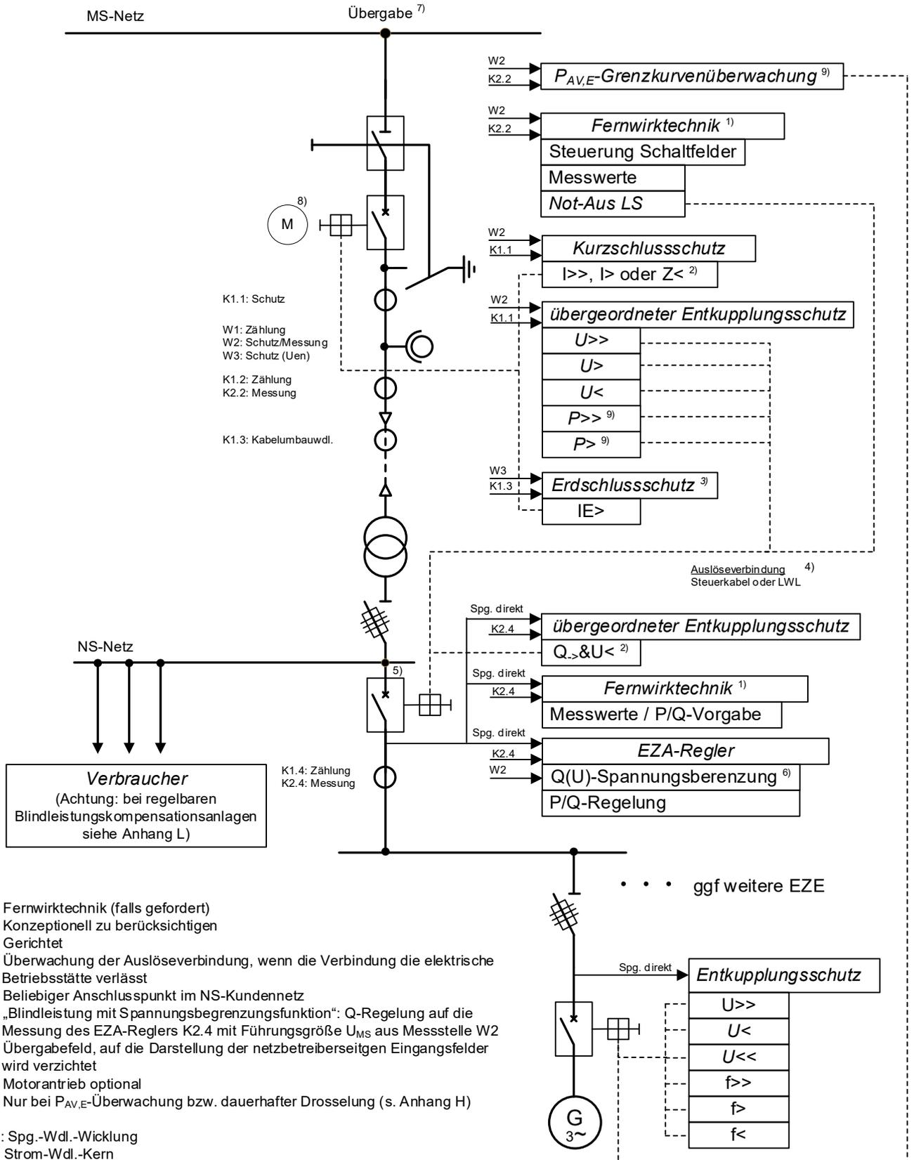
**Bild 9-Mischanlage** – Beispiel für eine an das Mittelspannungsnetz angeschlossene Kundenanlage mit Bezug und Erzeugungsanlage mit Lasttrennschalter und einer Erzeugungseinheit ohne Inselbetriebsmöglichkeit (Anschluss nicht in UW bzw. Schaltstation)
